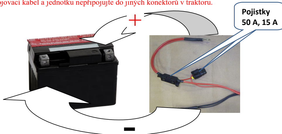
Obr. 7 - připojovací zásuvka na traktoru
