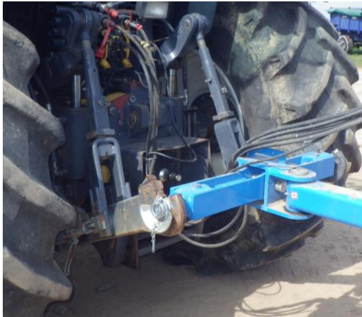
Aggregieren mit der hinteren TBZ-Aufhängung
