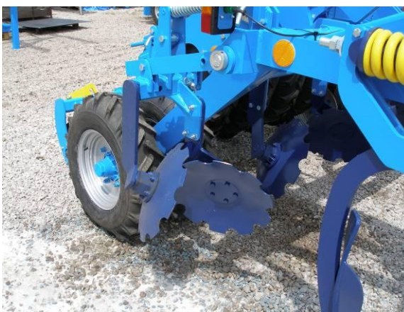
Rys.6 – boczne dyski kierunkowe w pozycji transportowej
