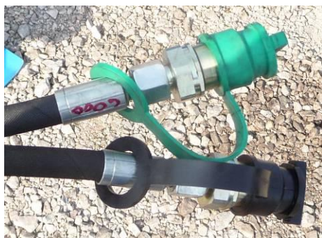
CZARNA, ZIELONA OSŁONA PRZECIWKURZOWA - hydrauliczna regulacja wysokości dysków
